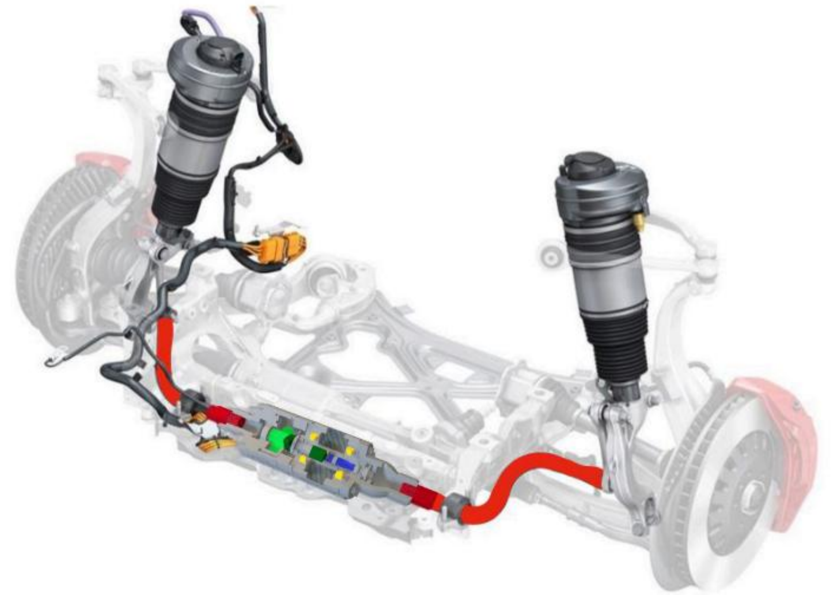
Fig. 1 — MRスタビライザシステムを搭載した前車軸.
